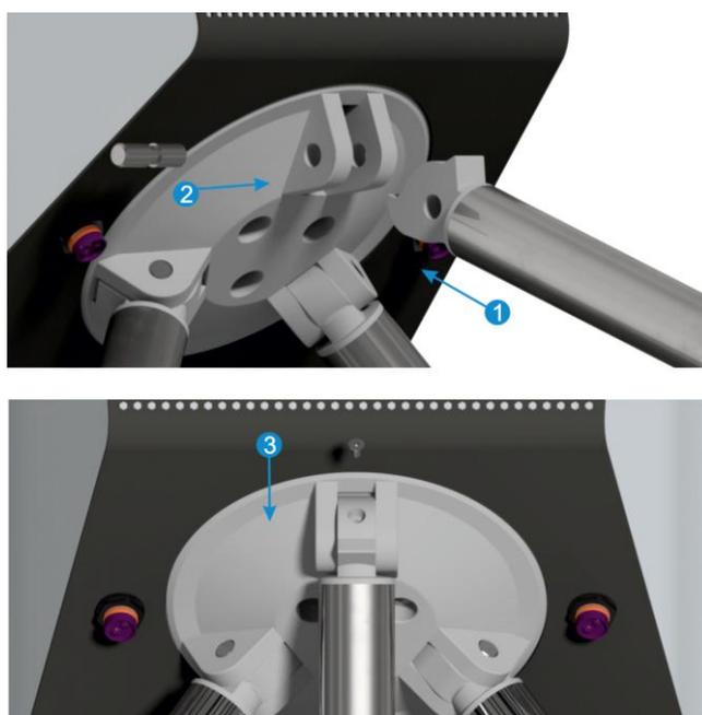
Рисунок 7.5.1 Установка преграждающих планок
